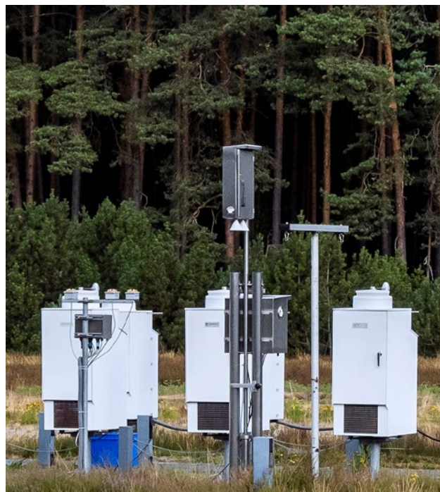
Messung von Ammoniak an der UBA-Hintergrundstation Waldhof (in Niedersachsen) mittels sog. Denuder (Bildmitte).
