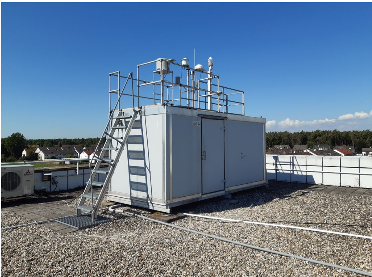
Die Experimentalstation Langen zur Messung von Ultrafeinen Partikeln liegt im städtischen Hintergrund des Rhein-Main-Gebiets. Hier betreibt das Umweltbundesamt eine von mehreren deutschlandweiten Messstationen im GUAN-Netzwerk (German Ultrafine Aerosol Network).
