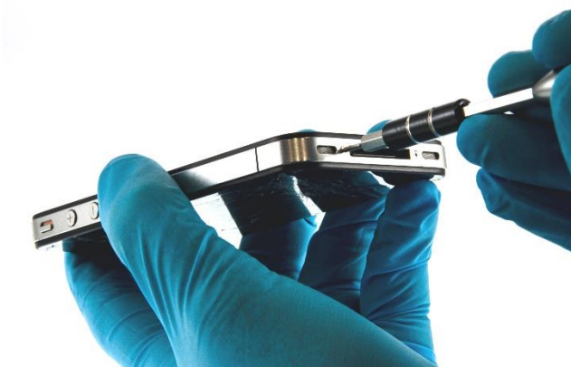
Abbildung 36: Arbeitsschritte zur Entnahme eines integrierten Akkus anhand DUT_6
