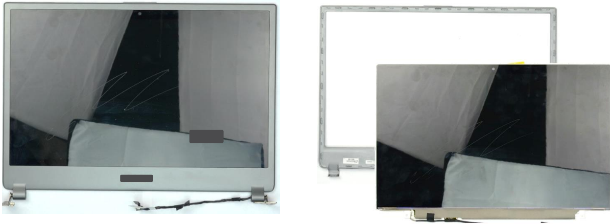
Abbildung 30: Separierung des Displaymoduls von Gehäuseteilen anhand DUT_5
