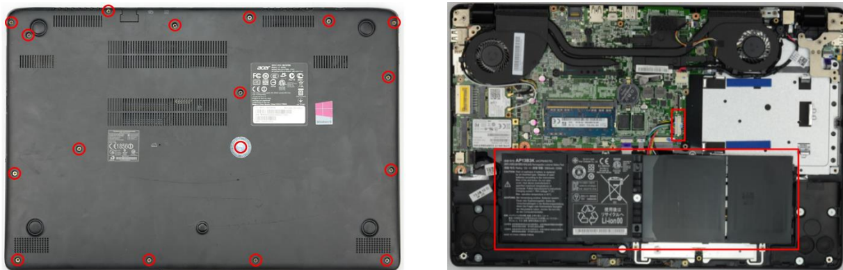
Abbildung 4: Öffnen des Gehäuses zur Entnahme eines integrierten Notebook-Akkus
