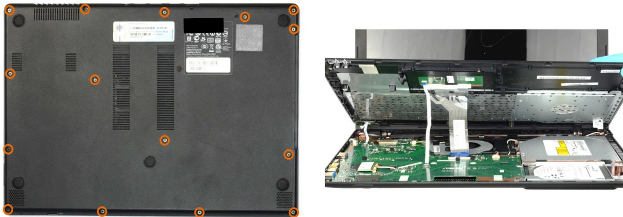
Abbildung 22: Öffnen des Gehäuses zur Entnahme von integrierten Notebooks Akkus anhand DUT_5 und DUT_6
