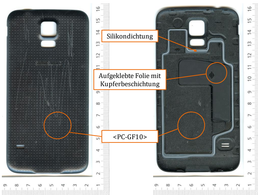
Abbildung 42: Beispielhafte Darstellung der werkstofflichen Zusammensetzung einer Smartphone Rückseitenabdeckung aus Kunststoff anhand DUT_2
