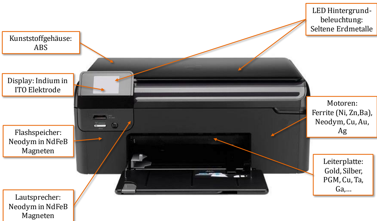
Abbildung 57: Beispielhafte Darstellung der Zielstoffe und Zuordnung zu Drucker Komponenten
