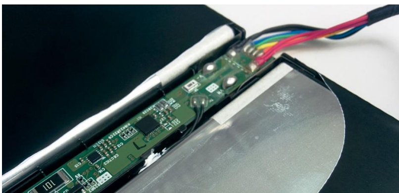
Abbildung 25: In das Akkupack integrierte Leiterplatte nach Entfernen der umgebenden Kunststoffolie
