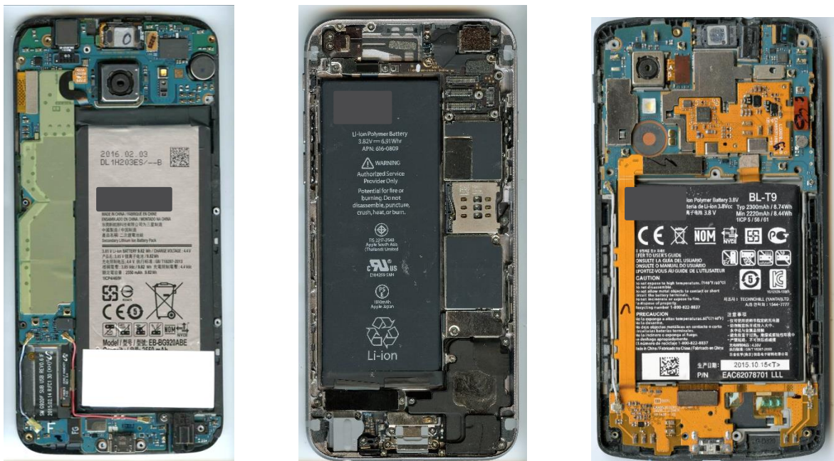
Abbildung 39: Beispiele für die zwei grundlegenden Typen des internen Smartphone Designs
