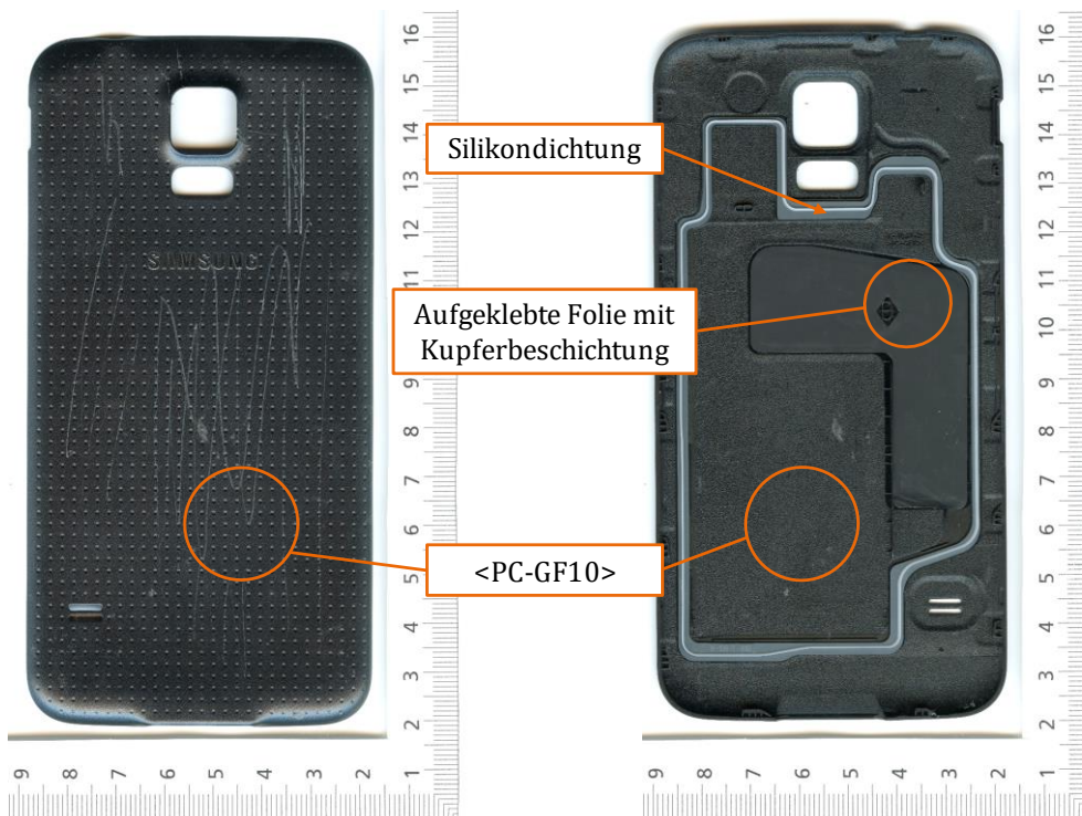
Abbildung 8: Beispielhafte Darstellung der werkstofflichen Zusammensetzung einer Smartphone-Rückseitenabdeckung aus Kunststoff
