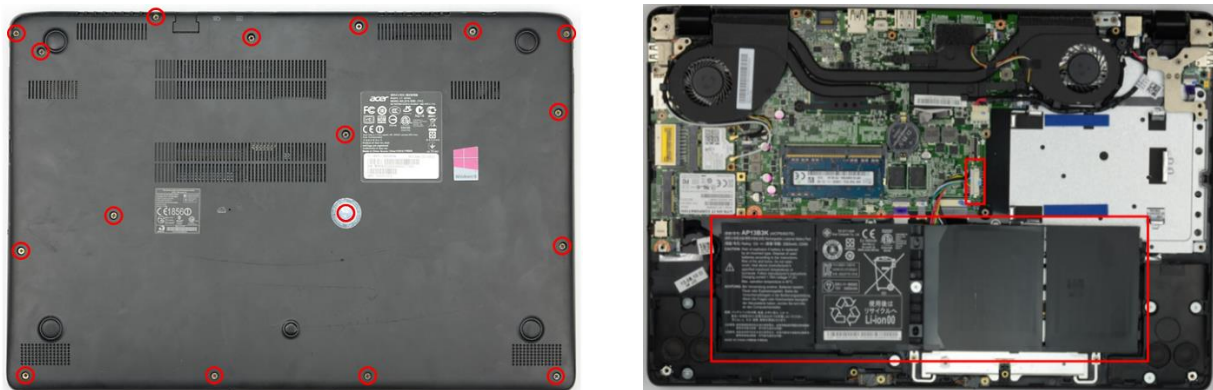
Abbildung 23: Öffnen des Gehäuses zur Entnahme von integrierten Notebooks Akkus anhand DUT_2
