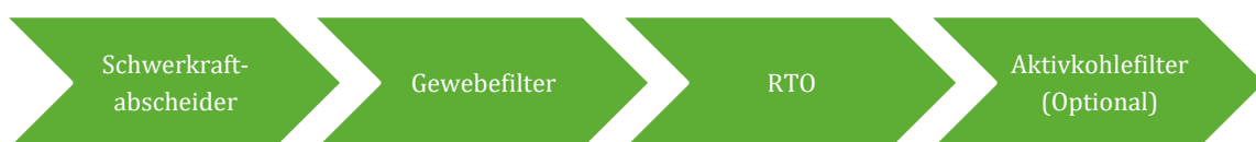
Abbildung 5: Grundlegende Komponenten der Abgasnachbehandlung der MPS-Anlagen
