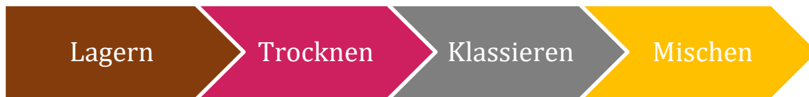
Abbildung 6: Verfahrensschema der Asphaltherstellung ohne Beachtung von Asphaltrecycling
