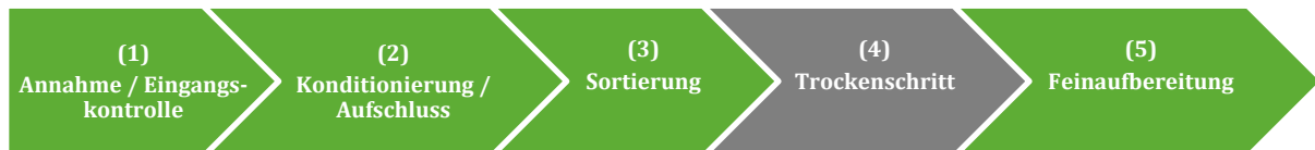
Abbildung 1: Wesentliche Verfahrensschritte bei der Herstellung von (Ersatz-) Brennstoffen (EBS) aus Abfällen
