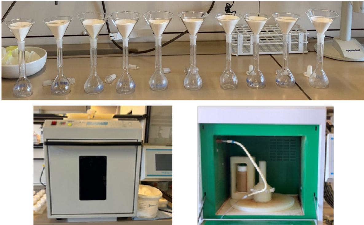
Abbildung 2: Probenvorbereitung für Königwasserauflösung und Innenaufbau eines Mikrowellen-Messgeräts mit eingebautem Rotor und Temperaturfühler.
