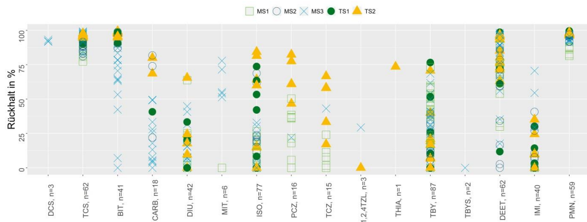
Abbildung 26: Einzelergebnisse für die Rückhalteleistung der Kläranlagen
