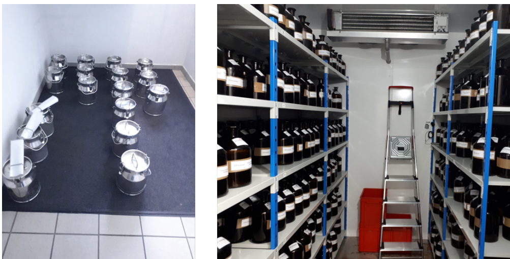
Abbildung 8: Auftauen der Wasserproben in den Edelstahlgefäßen (links) und Lagerung der abgefüllten Proben in der Kühlkammer (rechts)
