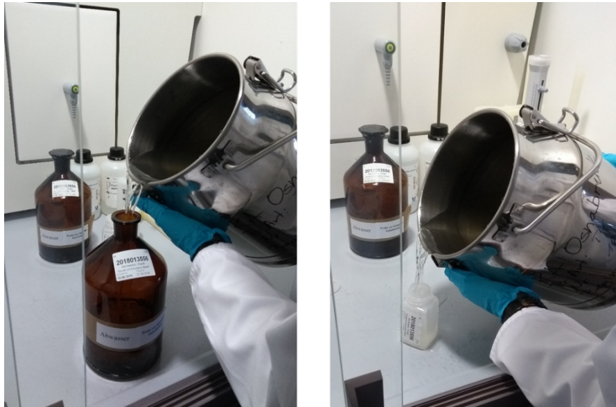
Abbildung 9: Umfüllen einer Wasserprobe aus dem Edelstahlgefäß in eine Braunglasflasche (links) und eine PE-Flasche (rechts)
