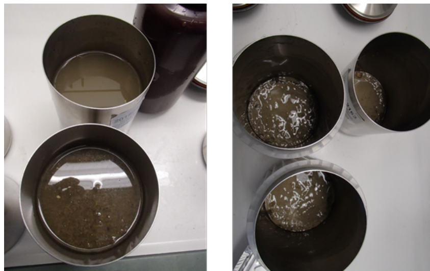
Abbildung 10: Klärschlammproben in den Zentrifugenbechern: Vor dem Zentrifugieren (links) und nach dem Zentrifugieren und Abdekantieren der Wasserphase (rechts)
