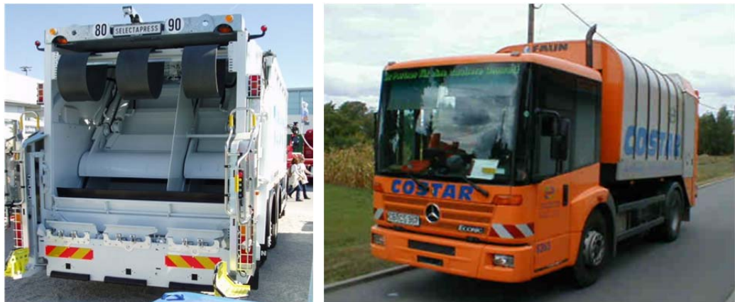
Figura 12: Vehículo con dos compartimientos de almacenamiento para la recolección diferenciada de de residuos (izq.) Vehículo con tambor rotatorio y cabina de conductor con entrada baja „Econic“ (der.) (Fuente de imágenes izq., der. : Intecus GmbH)
