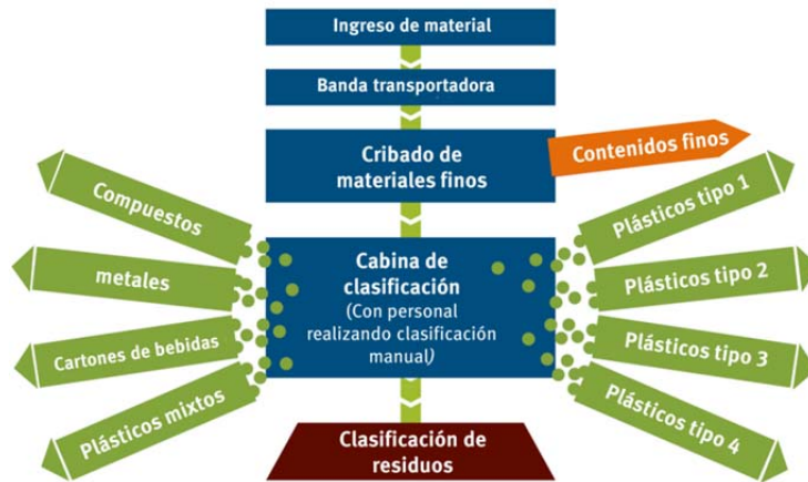
Imagen 4: Ejemplo de un proceso de clasificación para obtener diferentes fracciones de plásticos (configuración básica)
