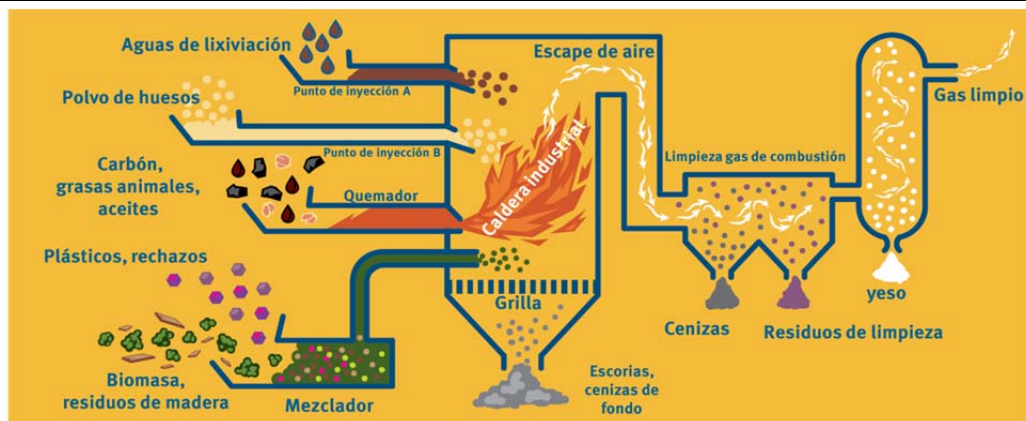
Imagen 1: Esquema de un ejemplo de co-incineración industrial en una central eléctrica
