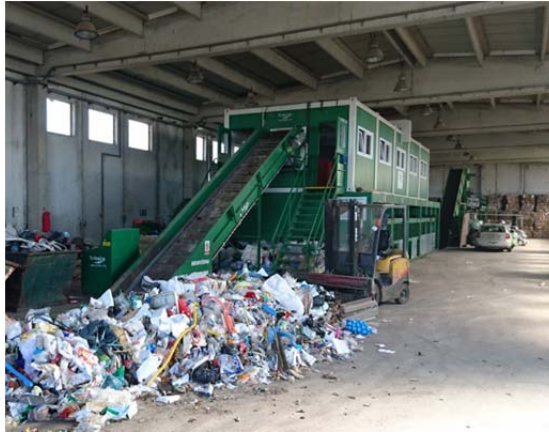
Imagen 5: Ejemplo de un planta de clasificación (configuración básica) (Foto: INTECUS)
