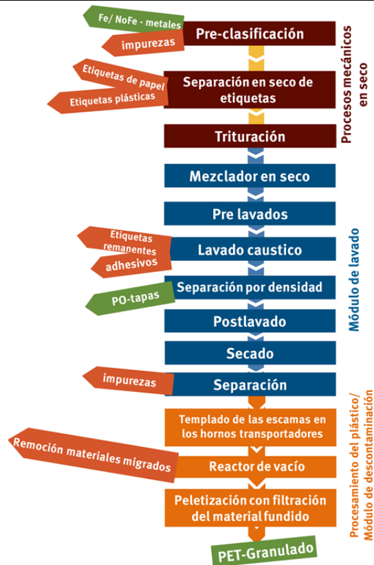
Imagen 7: Esquema del proceso de la empresa KRONES (esquema según KRONES AG, www.krones.de )
