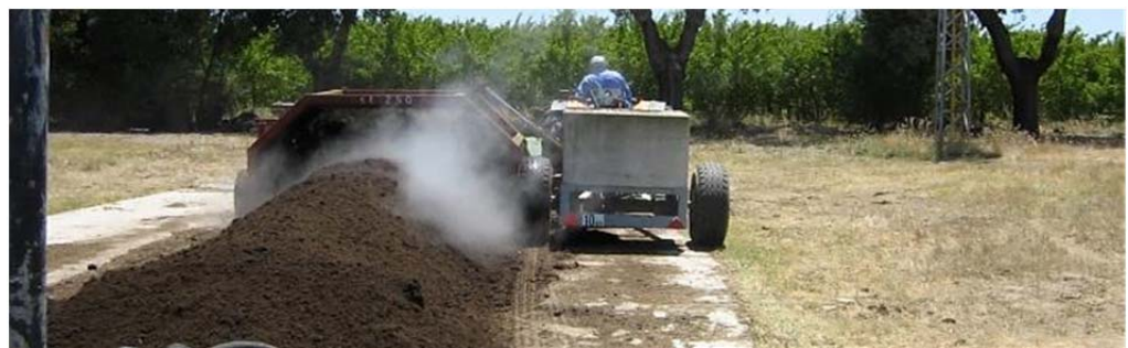
Figura 9: Ejemplo de aireación activa por volteo en un proceso dinámico (Fuente de imagen: Intecus)
