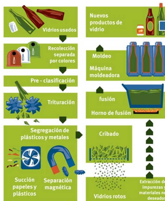
Figura 3: Proceso del reciclaje de residuos de vidrio
