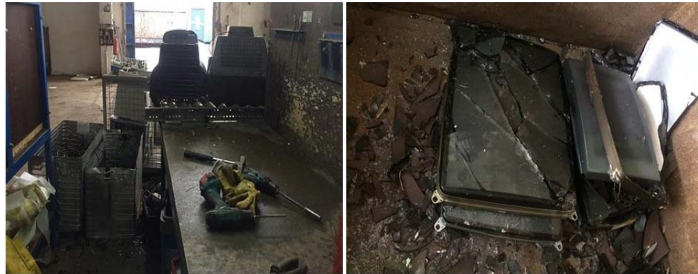
Figura 16: Lugar de trabajo para el desmantelamiento de monitores (izq.) y vidrios de monitores separados (der.) (Fuente de imágenes: INTECUS GmbH)
