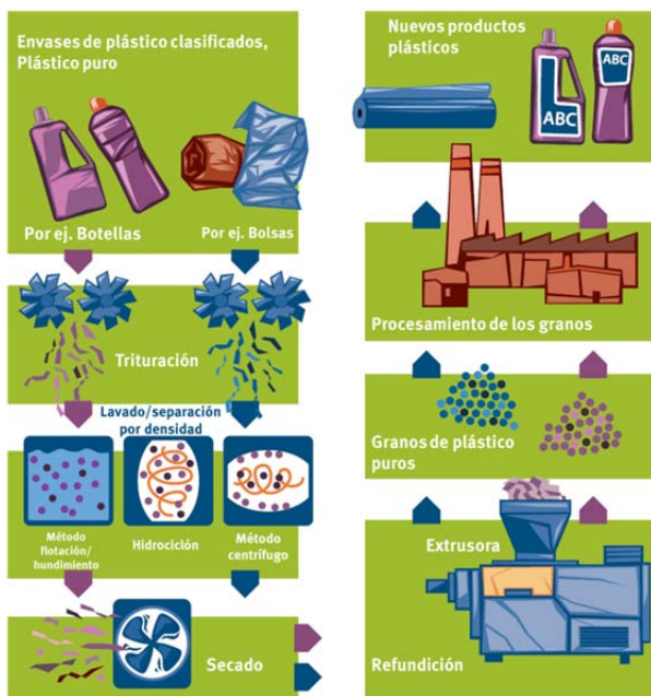
Figura 4: Reciclaje de envases de plástico no mezclado
