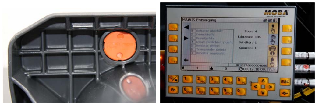
Figura 18: Transpondedor con un chip en un contenedor de residuos móvil (izq.) y computadora de a bordo en la cabina de un vehículo recolector (der.) (Fuente imagen izq. : c-trace GmbH, www.c-trace.de/ / Fuente imagen derecha. : Harald Heinritz, www.abfallbild.de/ )
