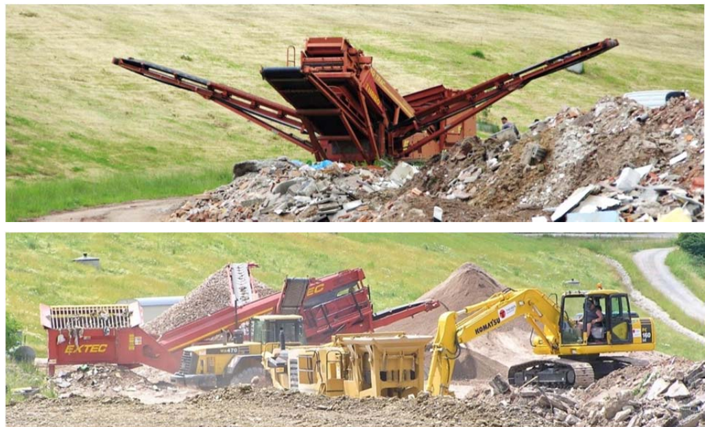
Figura 1: Equipo móvil de trituración de RCDs. (Fuente de imágenes superior e inferior: Jochen Zellner, Landkreis Neustadt/Aisch-Bad Windsheim , www.abfallbild.de )
