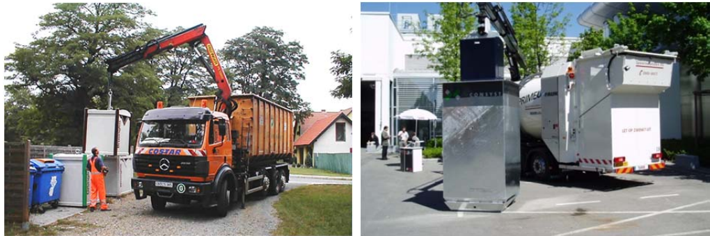
Figura 7: Vaciado contenedores de depósito (izquierda) y contenedores soterrados (derecha) (Fuente de imágenes: Intecus GmbH)
