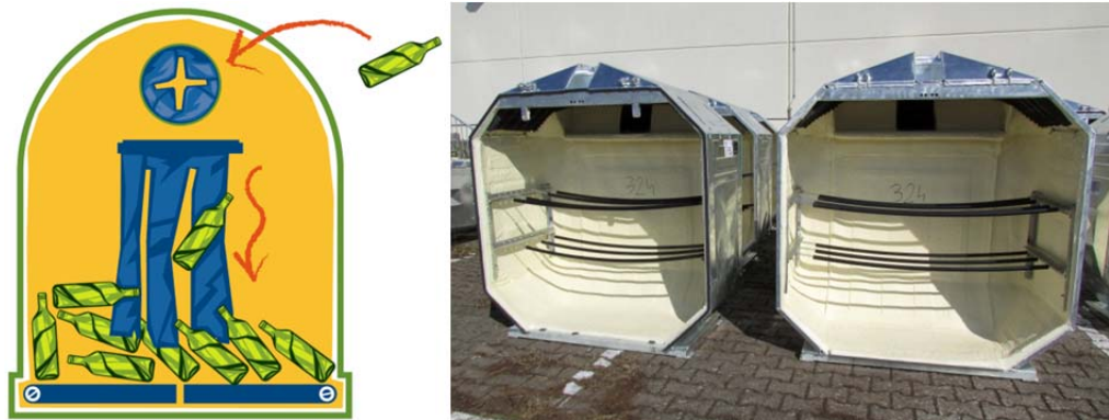
Figura 8: Esquema de contenedores de depósito con sistemas para reducir las emisiones de ruidos (Fuente de imagen derecha: Harald Heinritz, www.abfallbild.de )
