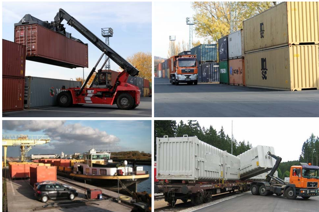
Figura 22: Contenedores intercambiables en transportes de calle (izq. arriba y der. arriba) (Fuente de imagen izq. y der. arriba: Petra Hoeß, FABION Markt + Medien / www.abfallbild.de ) / Estación de transferencia a barcos de contenedores intercambiables (izq. abajo) y tren con contenedores intercambiables con sistema ACTS (der. abajo) (Fuente de imagen izq. abajo: INTECUS GmbH / Fuente de imagen der. abajo: Autor: Priwo, Lizenz „Creative Commons Attribution/Share Alike“)
