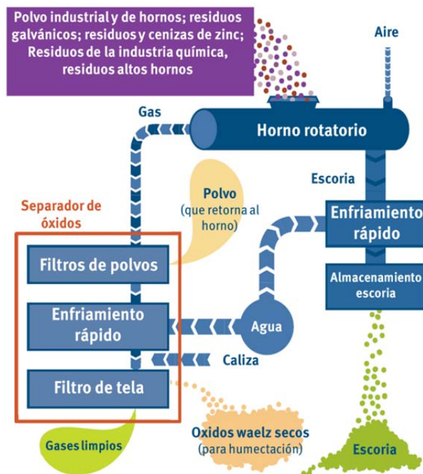
Figura 7: Esquema de el tratamiento de bateras usadas en un horno rotatorio
