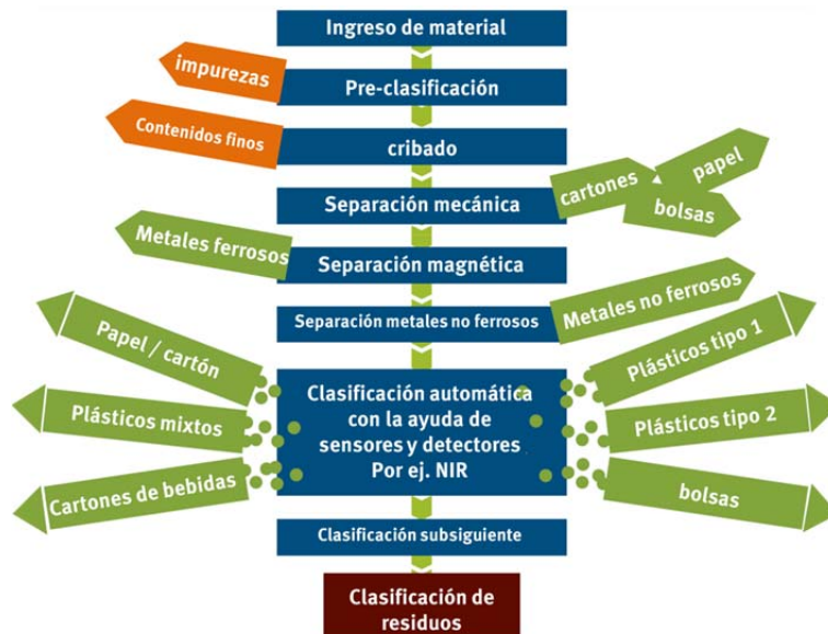
Imagen 6: Ejemplo de un proceso de clasificación de plásticos (configuración avanzada)
