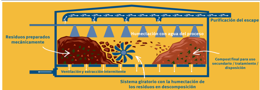
Figura 10: Esquema del compostaje en pilas en un compartimento cerrado. (Ensamblado según "Linde KCA")
