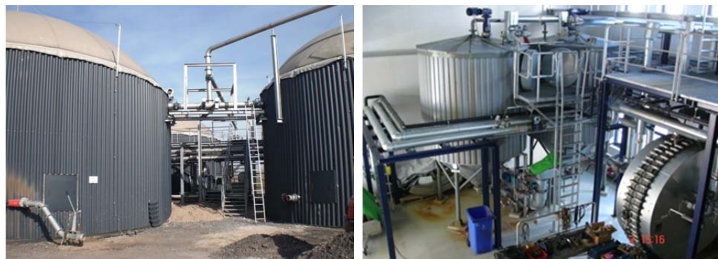
Figura 16: Imágenes de componentes de plantas con sistemas de digestión de residuos húmedos (Izquierda: reactores, derecha: sección de pretratamiento, Fuente de imágenes: Tim Hermann; Intecus)
