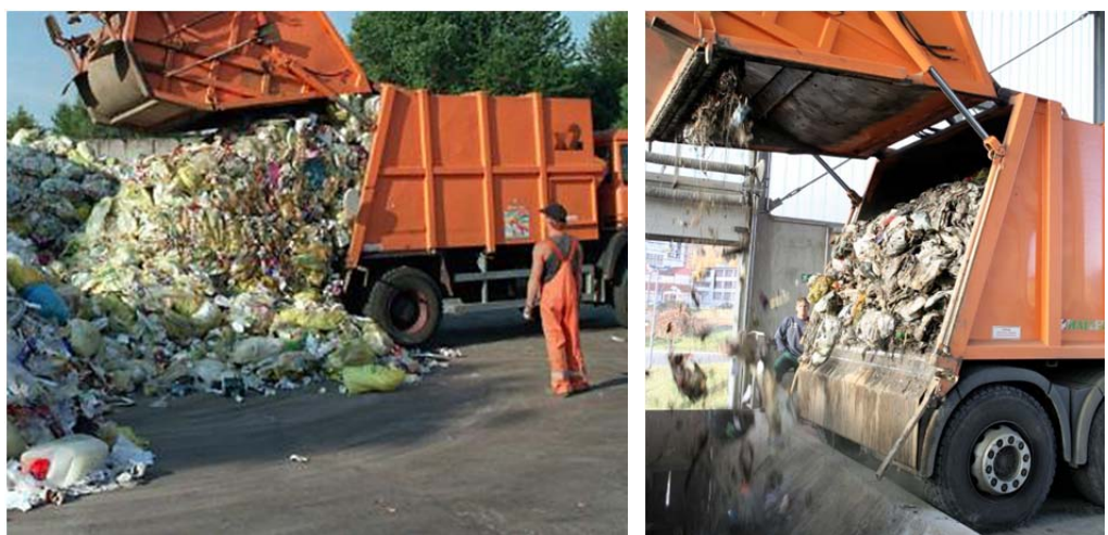
Figura 13: Vaciamiento del vehículo recolector con sistema de placa de presión para la compactación (izq., der.) (Fuente imagen izq. : Intecus GmbH, fuente imagen der. : Petra Hoeß, FABION Markt + Medien, www.abfallbild.de )
