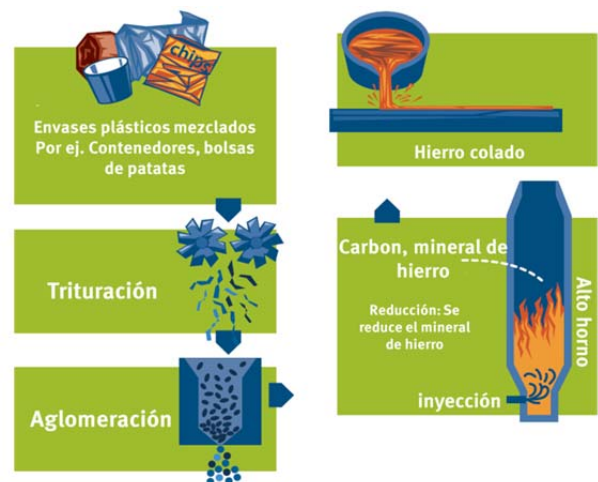
Figura 5: Reciclaje de envases de plástico mezclado
