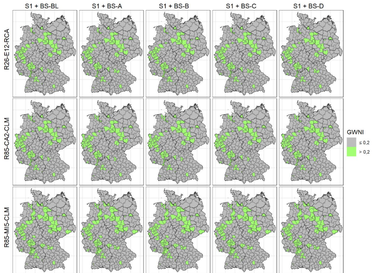
Abbildung 64: Überschreitung des Grundwassernutzungsindex (GWNI) in Abbildung 60 für den Schwellenwert 0,2.
