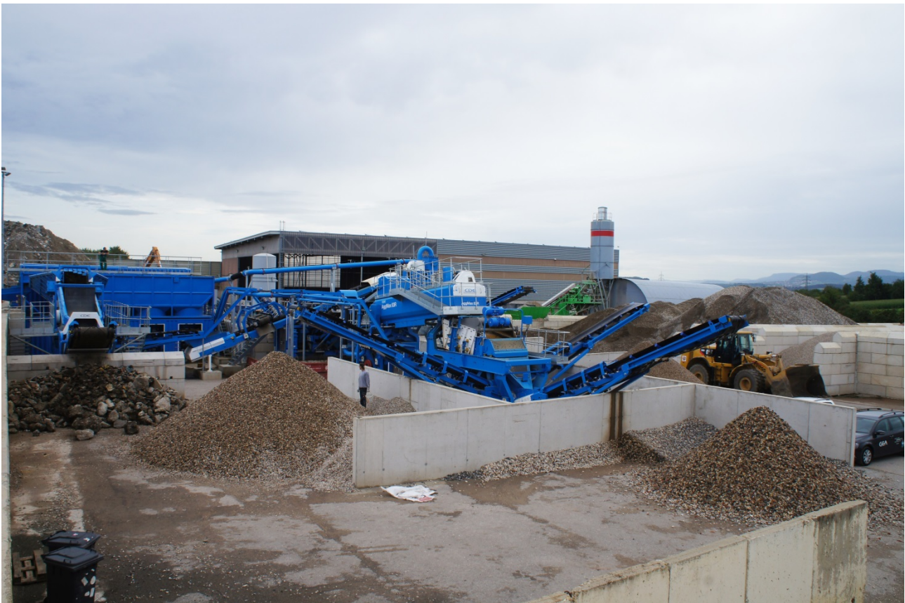
Abbildung 13: Aufbereitung über eine Schwertwäsche bei der Fa. Feeß in Kirchheim/T
