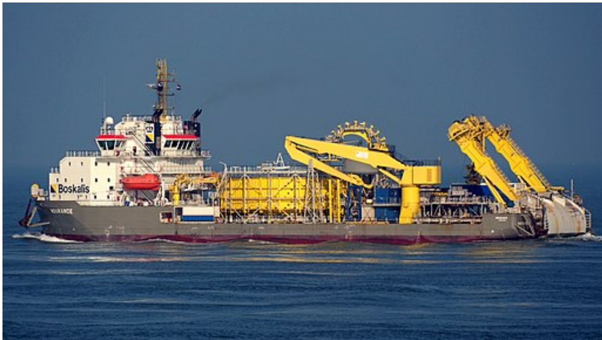
Abbildung 11: Verlegeschiff für Seekabel mit Kabeltrommel
