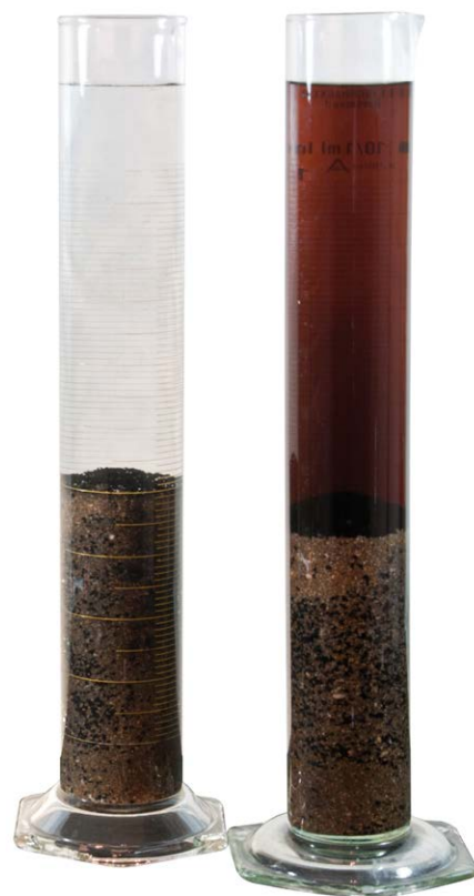
Abbildung 12: Ergebnis der Reinigung gebrauchter Filtrationsmaterialien mit Wasser (links) und speziellem Reinigungsmittel. Quelle: Dr. Nüsken Chemie GmbH.
