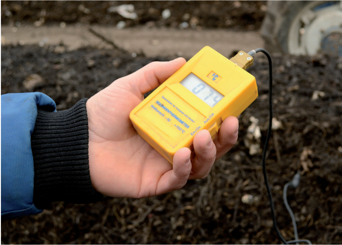
监测堆肥系统中的温度可以确保消灭病原体和杂草种子。
