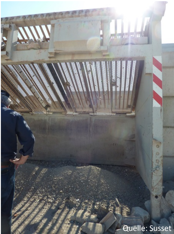
Abbildung 12: Aufbereitungsschritte eines Bauschutt auf einer stationären Bauschutt-Recyclinganlage: Links oben: Mit einer Vorsiebanlage wird die Fraktion < 22 mm vom Bauschutt abgetrennt und separat entsorgt. Rechts oben: Das Grobmaterial oberhalb des Vorsiebes wird weiter zu Recyclingbaustoffen aufbereitet. Unten: weitere Aufbereitung durch Brechen, Sieben und Magnetabscheidung von Eisen- und Stahlschrott mit einer modernen Brech- und Siebanlage (Quelle: eigene Fotografien).
