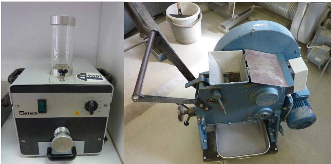
Abbildung 14: Zerkleinerung (Brechen) von Proben mit Backenbrecher 1 (links, Maximalkorn 22,4 mm) und Backenbrecher 2 (rechts: Maximalkorn 32 mm)
