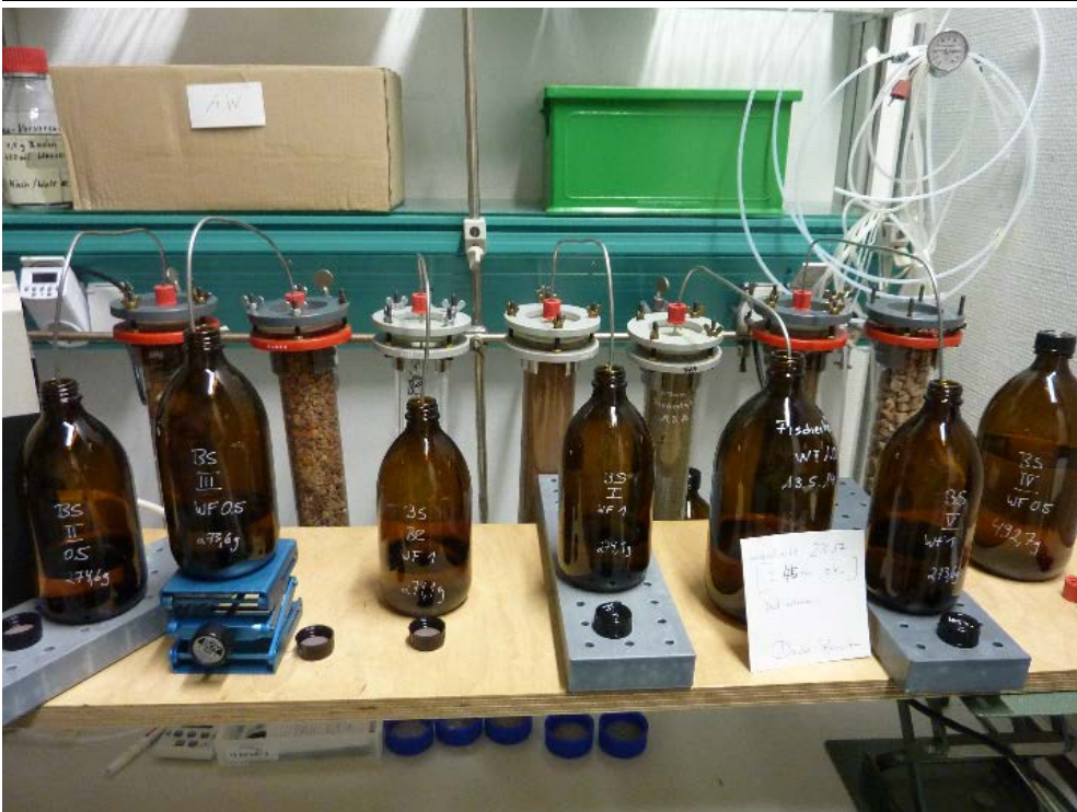
Abbildung 15: Säulenversuchsaufbau im Labor des ZAG Tübingen
