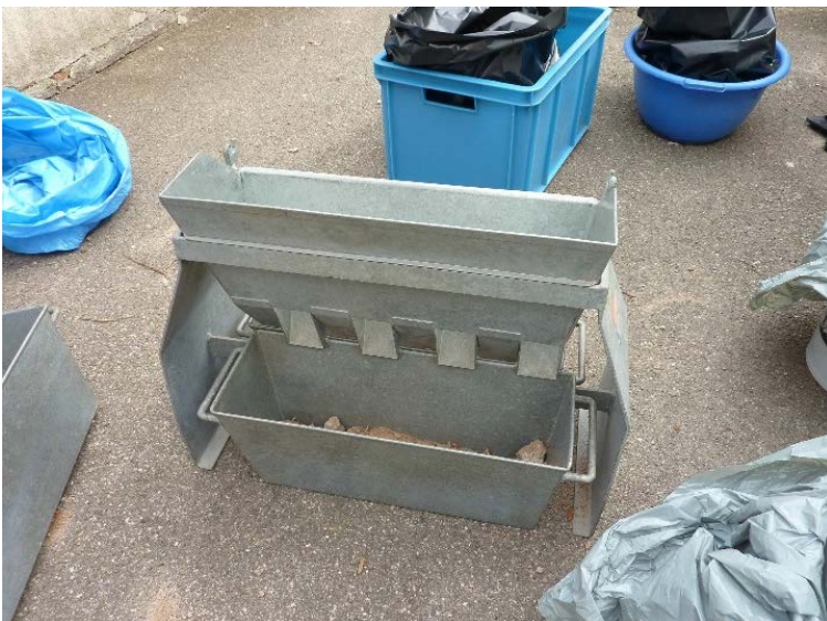
Abbildung 13: Probenteilung mit Riffelteiler
