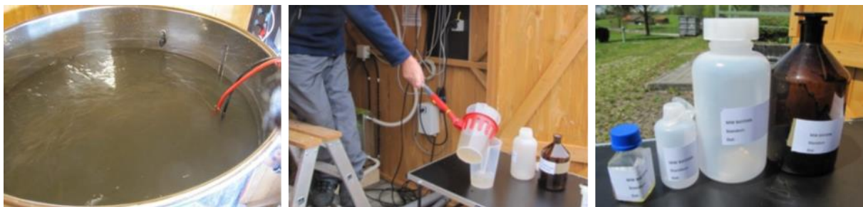
Abbildung 8: Homogenisierung mit Tauchpumpe im Feststoffsammler, Probenahmeflaschen, Entnahme der homogenisierten Mischprobe aus dem Feststoffsammler
