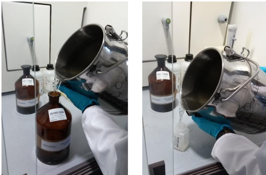
Abbildung 11: Umfüllen einer Wasserprobe aus dem Edelstahlgefäß in eine Braunglasflasche (links) und eine PE-Flasche (rechts)
