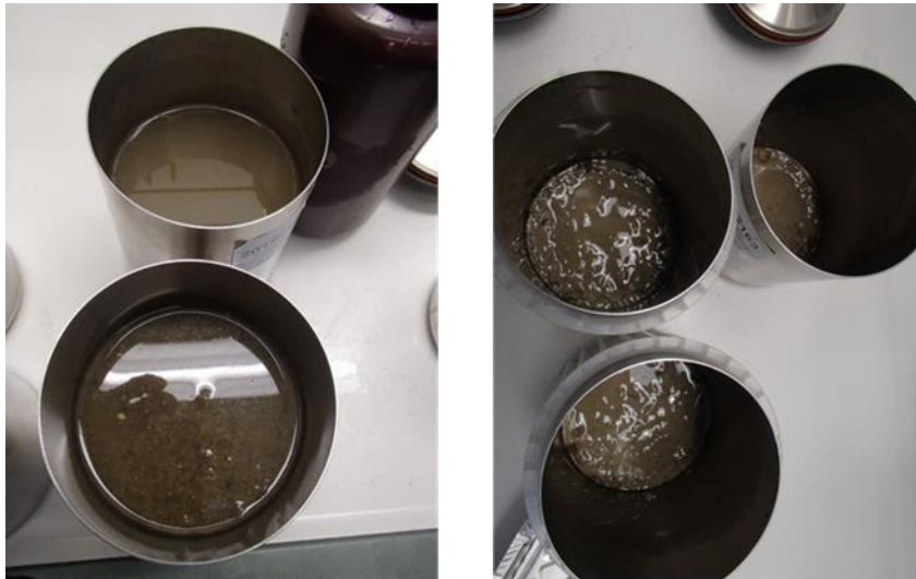
Abbildung 12: Klärschlammproben in den Zentrifugenbechern vor dem Zentrifugieren (links) und nach dem Zentrifugieren und Dekantieren der Wasserphase (rechts)
