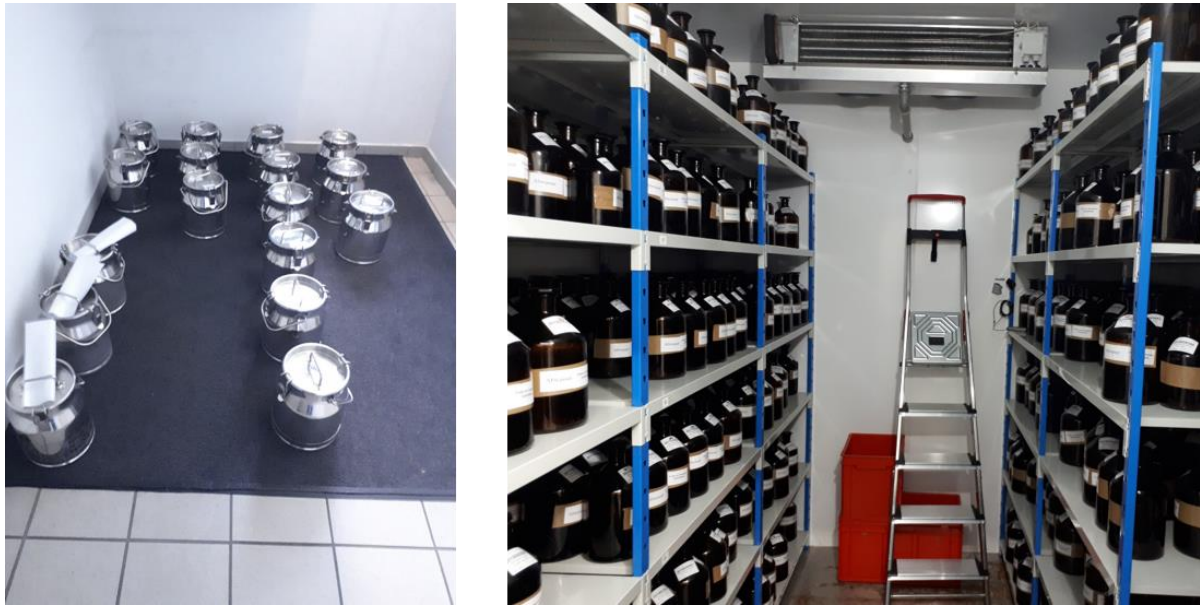
Abbildung 10: Auftauen der Wasserproben in den Edelstahlgefäßen (links) und Lagerung der abgefüllten Proben in der Kühlkammer (rechts)
