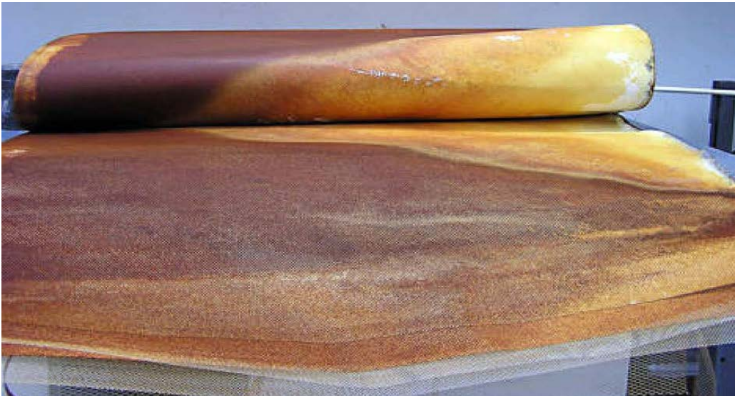
Abb. 46: Starkes Fouling an einer Umkehrosmosemembran (CDM Smith, 2008)
