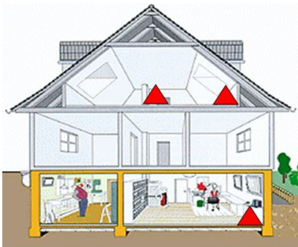
Abb. 120: Messpunkte im Gebäude, oberstes Vollgeschoss und Fundamentmesspunkt
