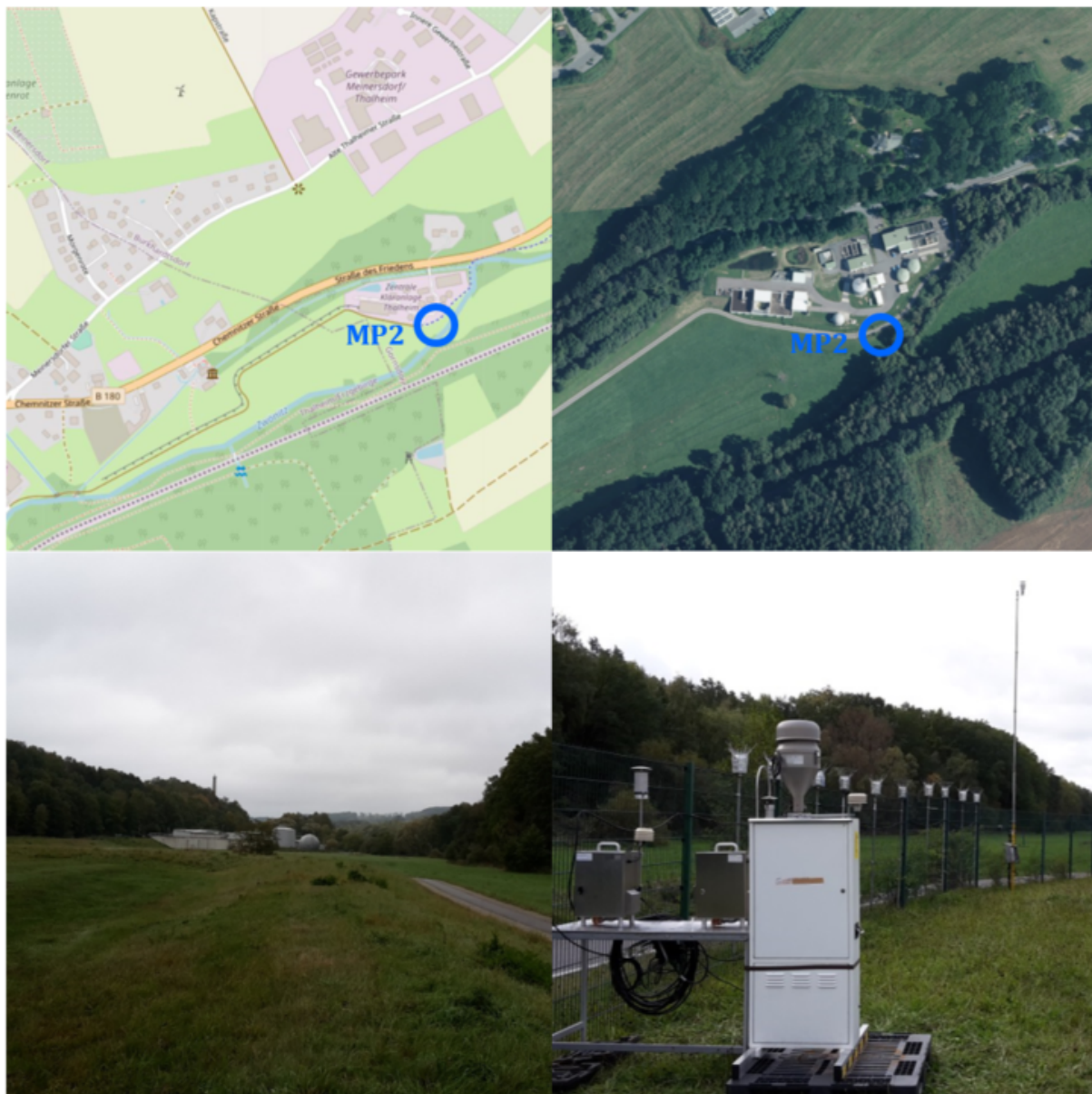
Abbildung 10: Übersichtskarte und Orthophoto von der Kläranlage bei Thalheim/Erzgeb. mit Fotos von Messpunkt 2 und der dort installierten Probenahmegeräte zur Bestimmung von PCDD/F in Außenluft und Deposition und meteorologischer Daten
