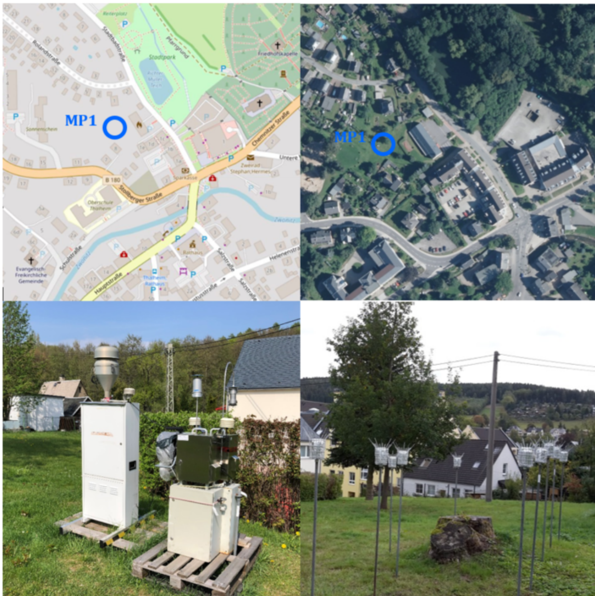
Abbildung 9: Übersichtskarte und Orthophoto vom Zentrum Thalheim/Erzgeb. mit Fotos von Messpunkt 1 und der dort installierten Probenahmegeräte zur Bestimmung von PCDD/F in Außenluft und Deposition
