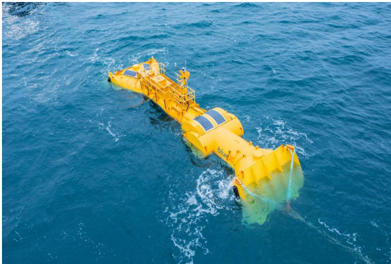
Abbildung 33: Konzept Mocean Energy Blue X im European Marine Energy Centre EMEC
