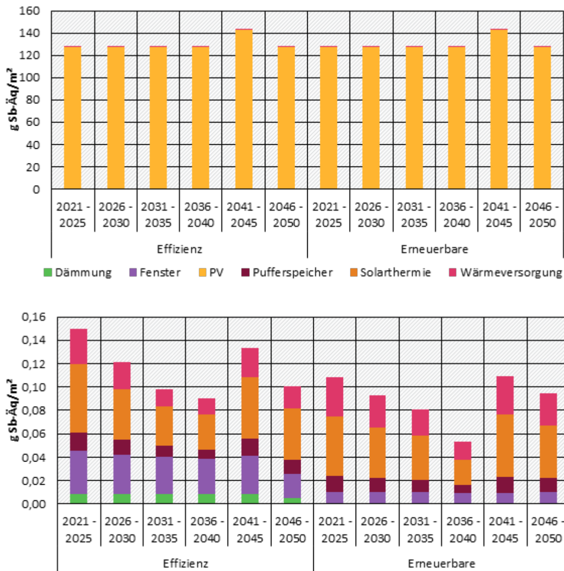
Abbildung 4-22: ADPE in g Sb-Äq pro Quadratmeter Bruttogeschossfläche; links EFF; rechts EE; oben inkl. PV; unten exkl. PV
