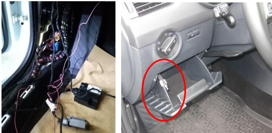
Abbildung 25: Verkabelung der Steuereinheit
