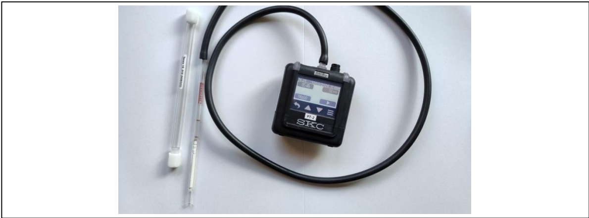
Abbildung 5-12: Foto eines Sorptionsrohrs neben seinem Container sowie Probenahmepumpe mit Schlauch
