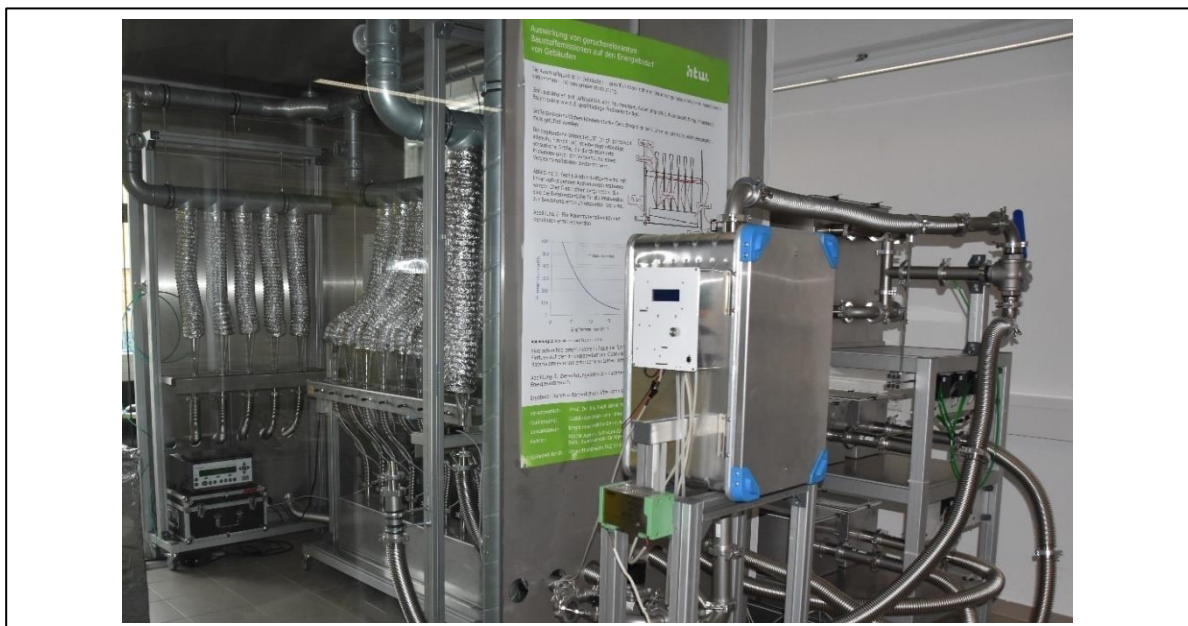
Abbildung 5-2: Blick in das Luftqualitätslabor vom Eingang aus fotografiert: Prüfraum mit Trichtern zur Probenluftdarbietung und Vergleichsmaßstab (links), Adapter (vorn) und CLIMPAQs (rechts)
