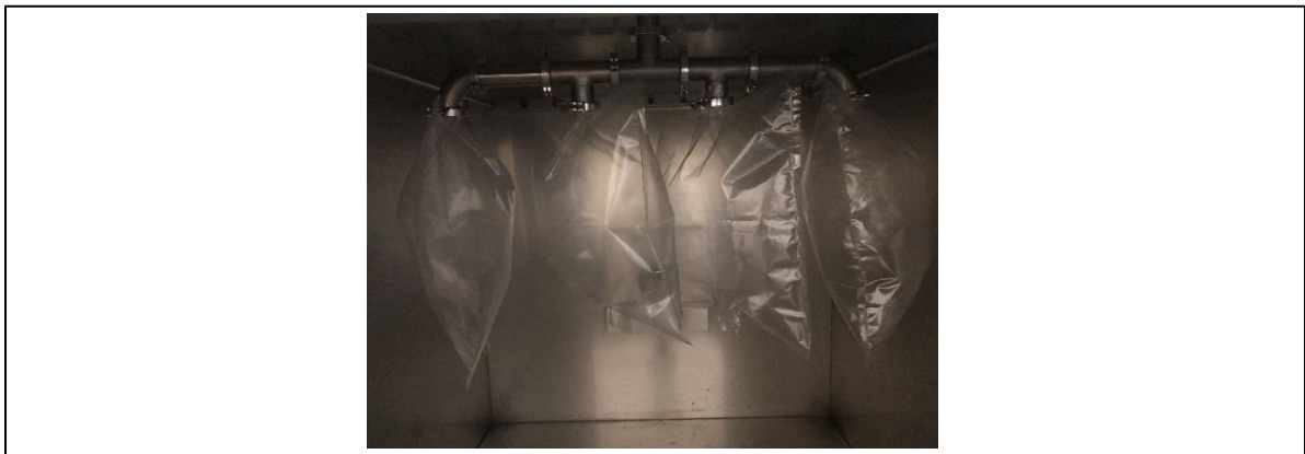
Abbildung 5-8: Foto des Ofeninnenraumes mit Probenbehältern aus Tedlar® zum Ausheizen
