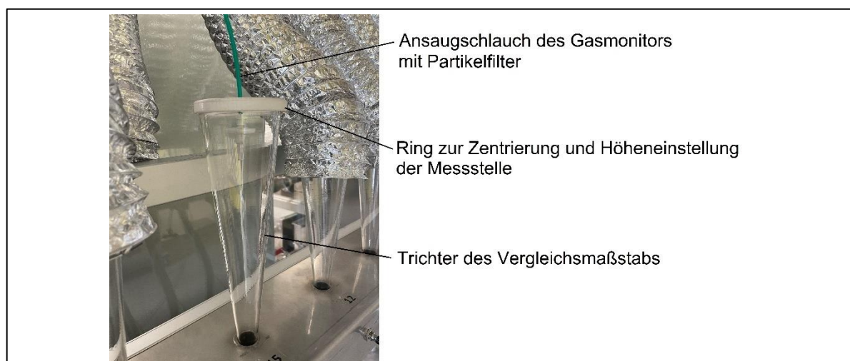
Abbildung 5-4: Ansaugschlauch des Gasmonitors über einem Trichter des Vergleichsmaßstabes zur Messung der Acetonkonzentration
