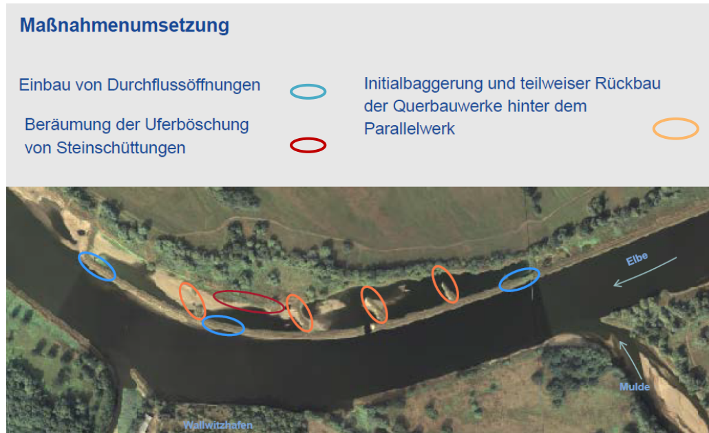
Abb. 9: Maßnahmen zur ökologischen Aufwertung des Parallelwerks Wallwitzhafen
