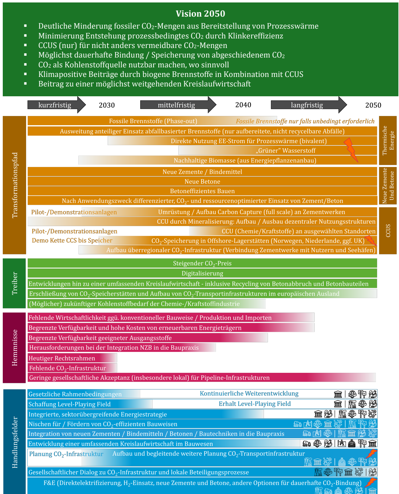
Abbildung 17: Vision und Roadmap zur Dekarbonisierung der Zementindustrie
