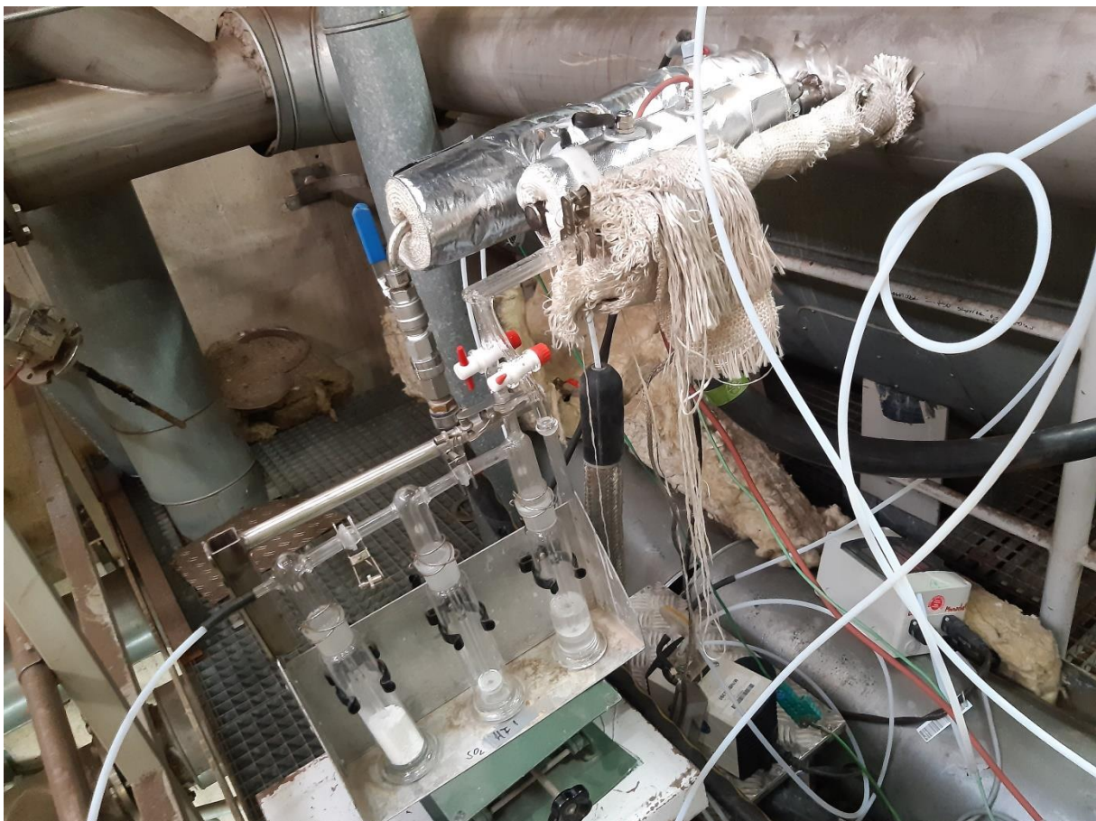
Abbildung 26: Messkonzept (Klärschlamm trocknungsanlage mit Scheibentrockner)
