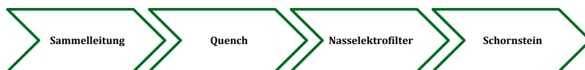
Abbildung 18: Prinzipieller Ablauf der Abgasnachbehandlung an direkt trocknenden OSB-Plattentrocknern
