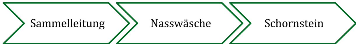
Abbildung 21: Prinzipieller Aufbau der Abgasnachbehandlung hinter Stromrohtrocknern
