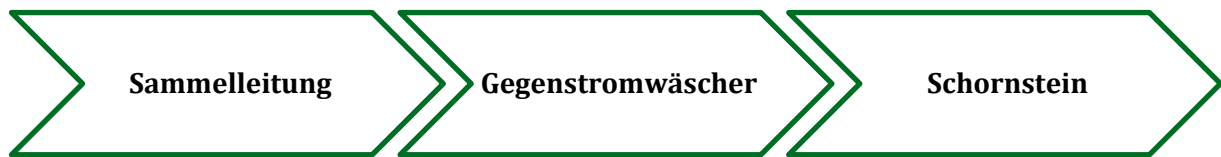
Abbildung 27: Prinzipieller Aufbau einer Abgasnachbehandlung hinter indirekt beheizten Stromrohrtrocknern für Fasern
