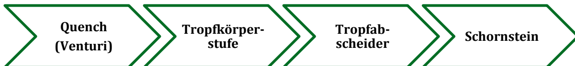
Abbildung 24: Prinzipieller Aufbau einer Abgasnachbehandlung hinter direkt beheizten Faser Trocknern mit Tropfab-scheider (Standort 4)
