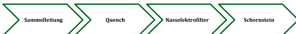
Abbildung 12: Prinzipieller Ablauf der Abgasnachbehandlung an direkt trocknenden Spanplattentrocknern.
