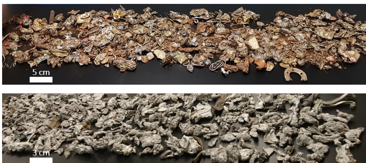
Abbildung 3-16: Bilder zweier Proben, die aus dem Recyclingprozess nach einem Großschredder und erster Vorsortierung entnommen wurden, aus dem Stahlrecycling (oben) bzw. aus dem Aluminiumrecycling (unten)
