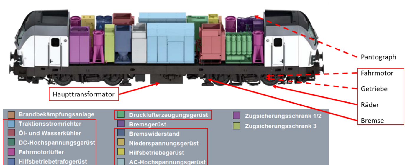
Abbildung 23: Schallquellen einer Mehrsystem-Lokomotive höherer Leistungsklasse
