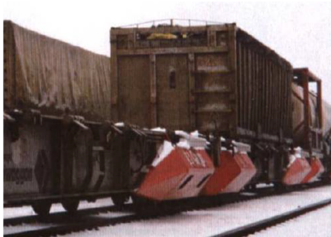
Abbildung 38: Schallschürzen am Drehgestell
