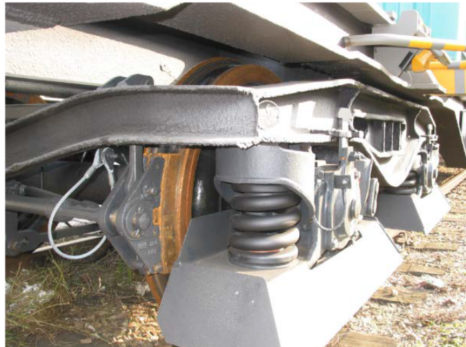
Abbildung 39: Schallschürzen an Radsätzen
