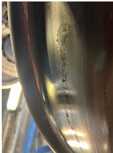
Abbildung 33: Beispiel einer Martensit-Insel an einem Güterwagen der Hupac AG
