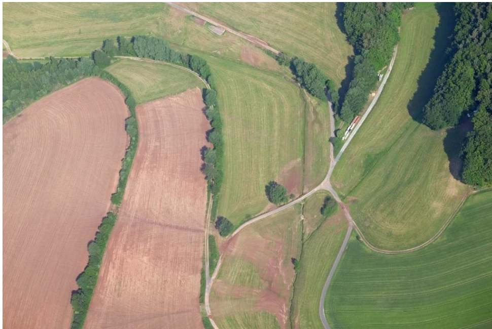
Abbildung 27: Luftbildaufnahme nach einem Starkregenereignis in Osthessen im Mai 2018 (über 80 mm innerhalb von weniger als drei Stunden) mit Erosionsschäden (on- und off-site)
