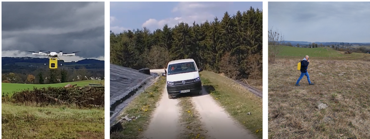
Abbildung 6: Bisher erprobte und mögliche Vehikel für den Transport des FTIR entlang unterschiedlicher Messstrecken zur Konzentrationsermittlung
