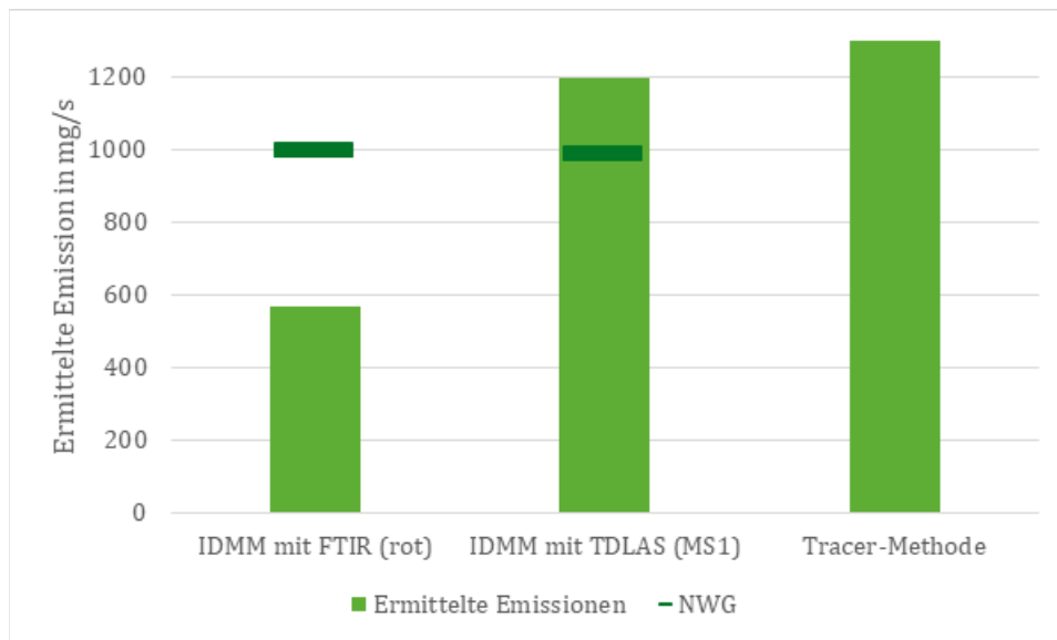
Abbildung 14: Ergebnis der Emissionsquantifizierung am 31.05.2023 an der Deponie Dibbersen für die Konzentrationserfassung mit FTIR und TDLAS
