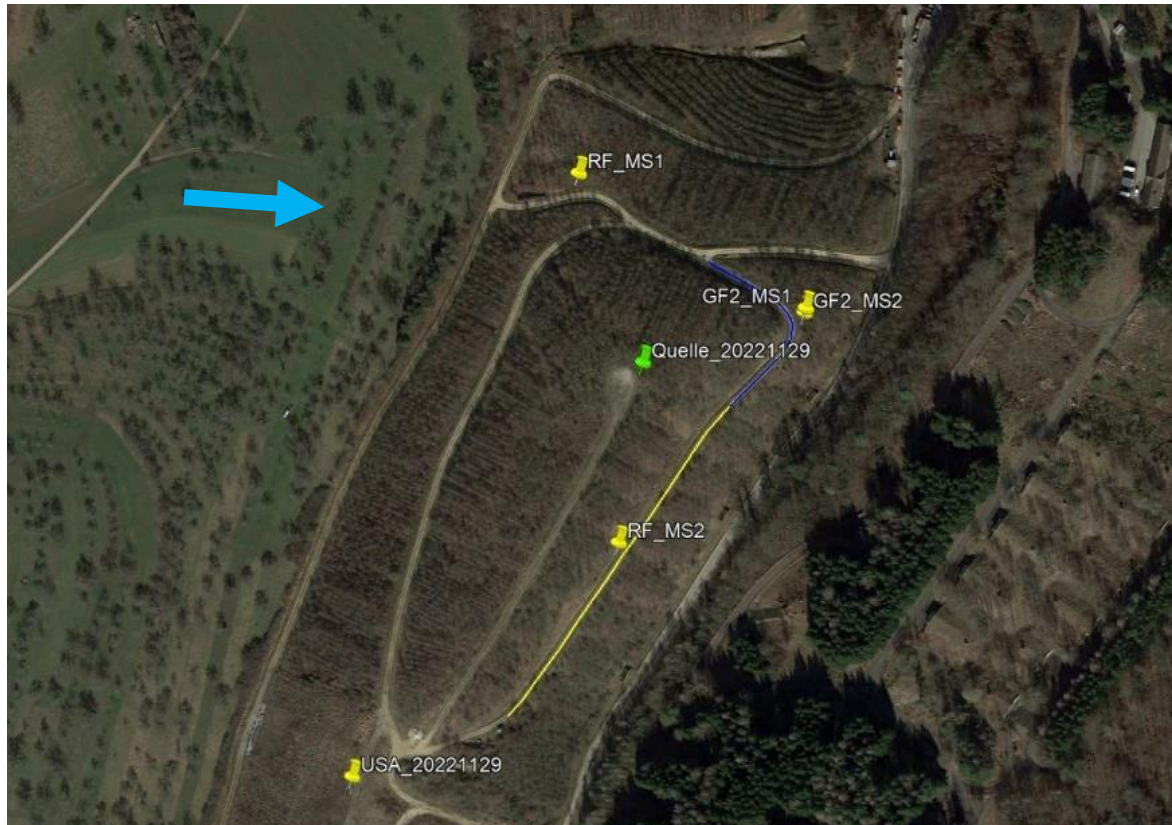
Abbildung 9: Luftbild der Deponie Blumentobel mit den Positionen des USA und der Quelle, sowie den Messstrecken für FTIR (blaue und gelbe Linie) und TDLAS (jeweils zwischen den gelben Markierungen) und der Windrichtung (hellblauer Pfeil) am 29.11.2022
