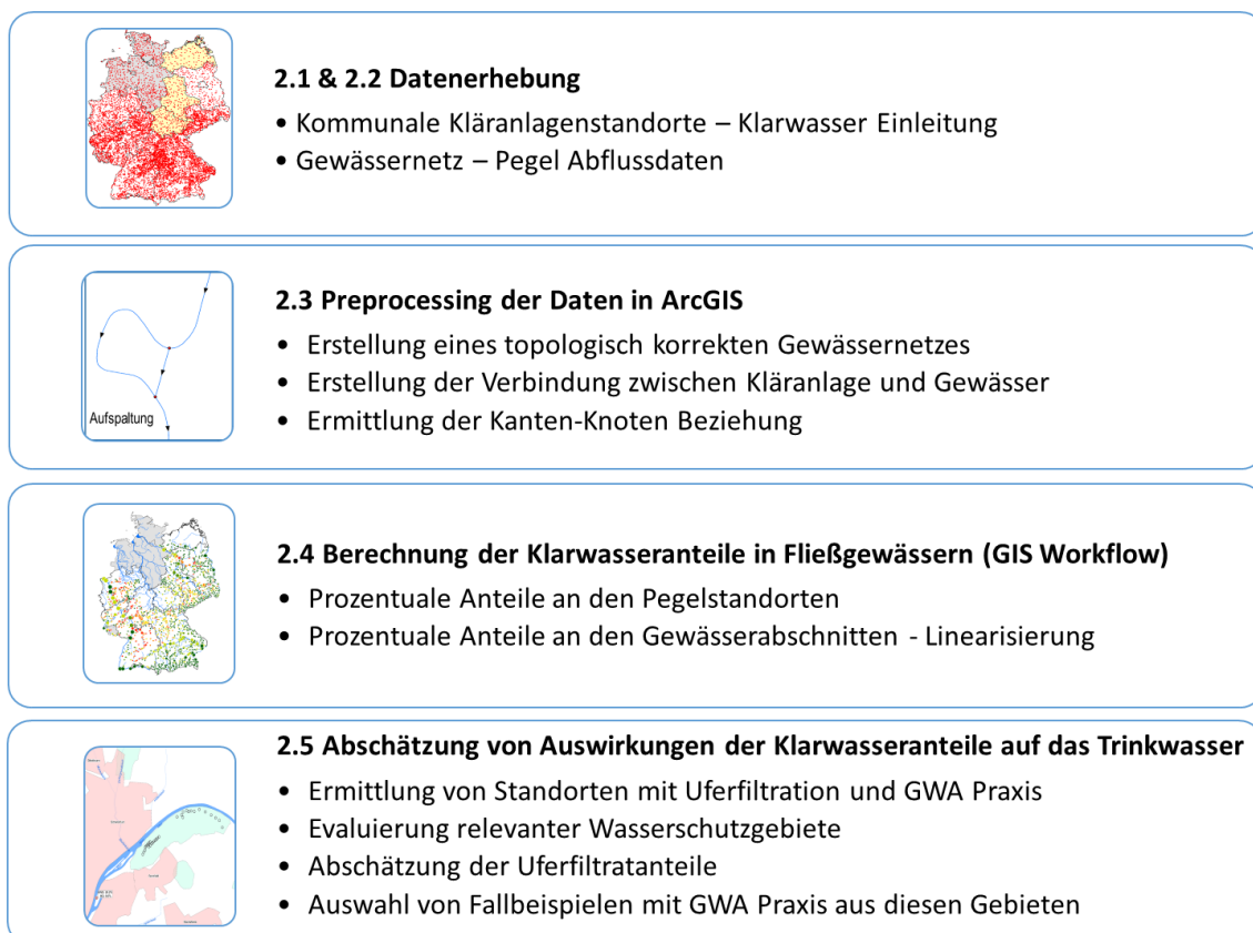
Abbildung 2: Methodisches Vorgehen zur Abschätzung der Auswirkungen von Klarwasseranteilen in Fließgewässern auf die Trinkwasserversorgung
