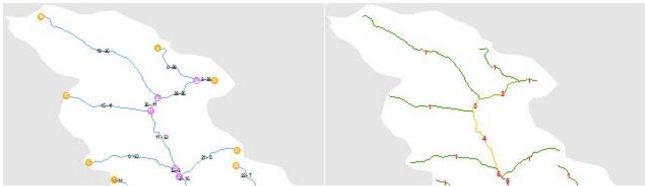
Abbildung 9: Ermittlung der Kanten-Knoten Beziehung (links) und der Flussordnungszahl (rechts) als Grundlage für die Aufsummierung der Kläranlagenabflüsse
