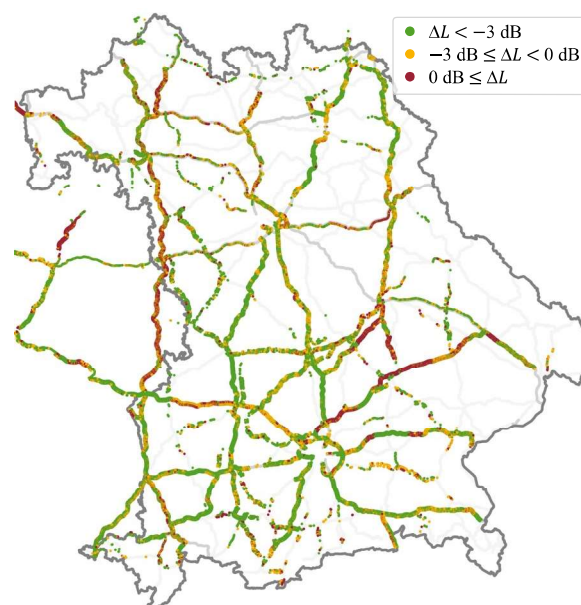
Abbildung 1: In der Karte ist die Pegeldifferenz \Delta L des mit den konsolidierten Übertragungsfunktionen bestimmten äquivalenten Fahrzeuggeräuschpegels für Pkw L_{AT,Pkw} bei 100 km/h zum entsprechenden maximalen Vorbeifahrtpegel gemäß den RLS-19 [10] pro untersuchtem Straßensegment eingetragen. Rot markiert Differenzen, die größer sind als 0 dB und grün, die kleiner sind als -3 dB. Gelb kennzeichnet Unterschiede zwischen 0 und -3 dB.
