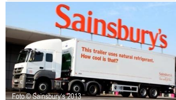
Mobile CO 2 -Kälteanlage im Feldversuch
