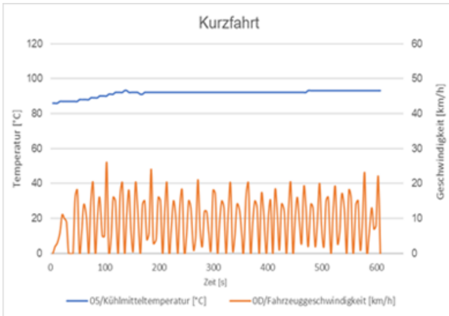
Abbildung 109: Fahrzeug 10 – 15x Kurzfahrt Straße – OBD-Daten und NO x -Verlauf
