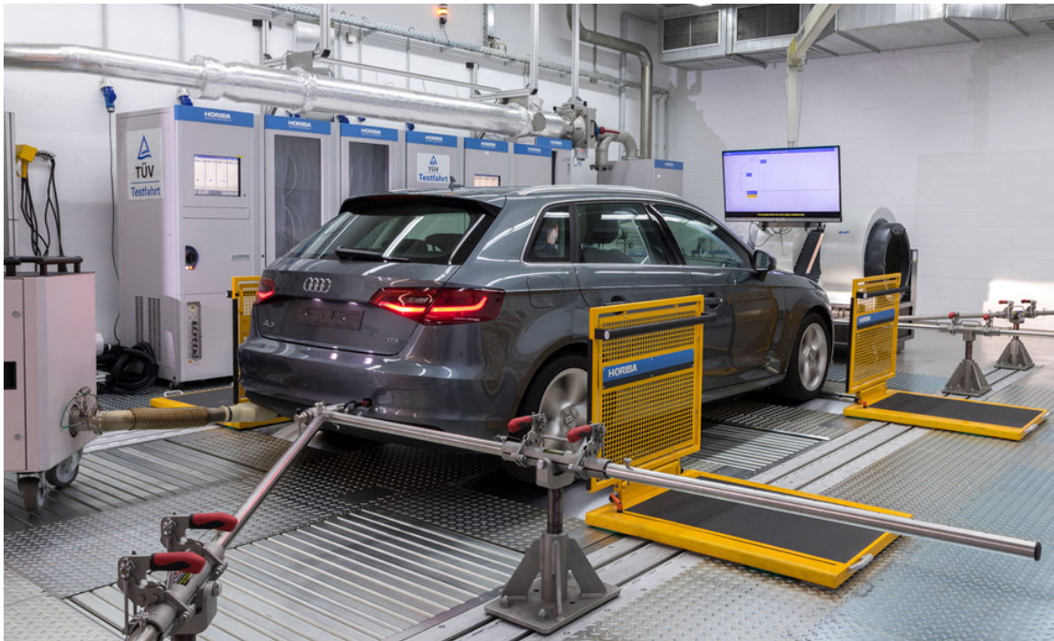
Abbildung 3: Prüffahrzeug auf Horiba Rollenprüfstand
