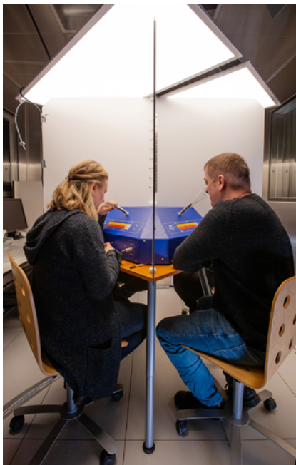
Abbildung 1 TO8-Olfaktometer mit erweiterten Sichtschutzblenden und LED-Panel im ExpoLab
